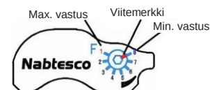
Kuva 12 Taiputuksen säätöventtiilin asteikko.
