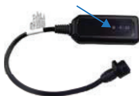
Lámpara LED en el cargador de baterías
