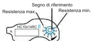
Fig. 14 Scala graduata della valvola di regolazione dell'estensione
