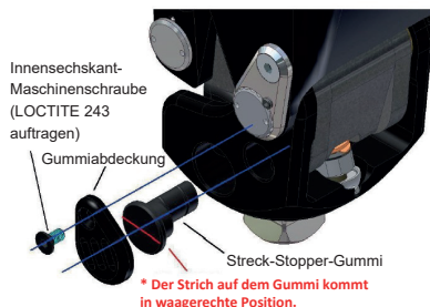
Fig. 19: Ersetzen des Streck-Stopper-Gummis
