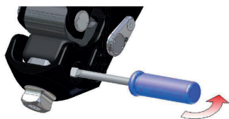
Fig. 20 Rimozione della gomma di appoggio-flessione
