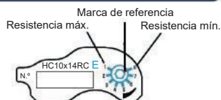
Imagen 14. Escala de la válvula de ajuste de la extensión
