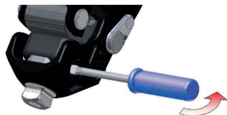
Fig. 20: Entfernen des Stand-Beuge-Gummis
