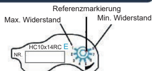
Fig. 14: Skala des Ventils zum Einstellen der Streckung
