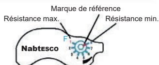
Fig. 12 Échelle graduée du clapet de réglage de la flexion
