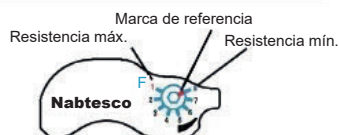
Imagen 12. Escala de la válvula de ajuste de la flexión
