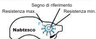
Fig. 12 Scala graduata della valvola di regolazione della flessione
