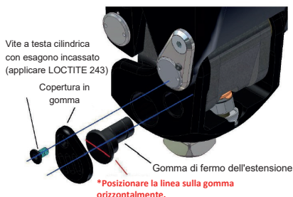
Fig. 19 Sostituzione della gomma di fermo dell'estensione
