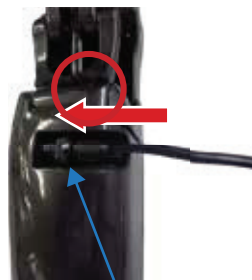
Kontakt for batterilader
