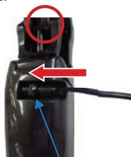
Conector del cargador de batería
