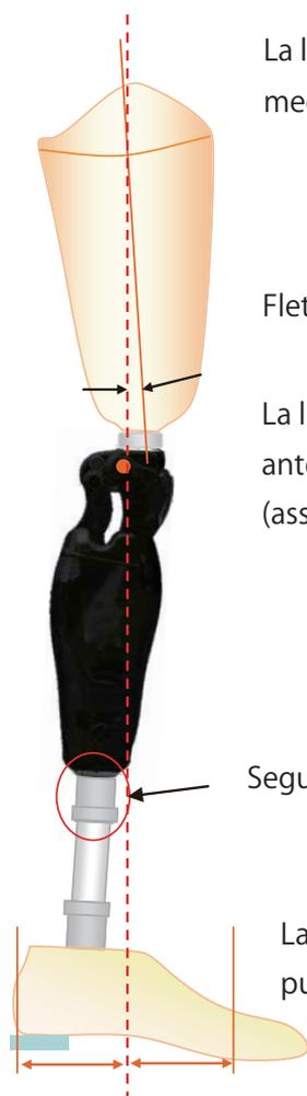
La linea di carico deve passare attraverso la linea mediana dell'incavo nella parte superiore dello stesso.
