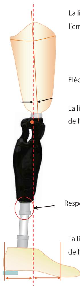
La ligne de charge doit passer au milieu de l'emboîture, sur le haut de celle-ci.
