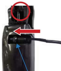
Conector del cargador de batería
