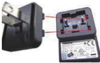
● Conecte el cargador de baterías y el adaptador de CA.
