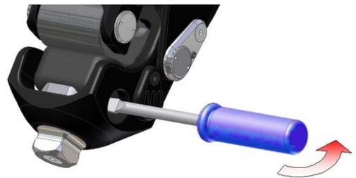
図20 バウンシングゴムの取り外し
