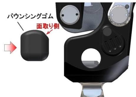
図21 バウンシングゴムの挿入
