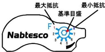
図12 屈曲側調整バルブの目盛
