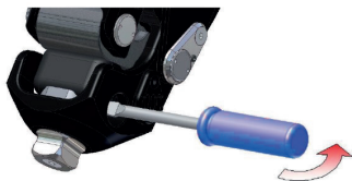
Afb. 20 Het standflexierubber verwijderen
