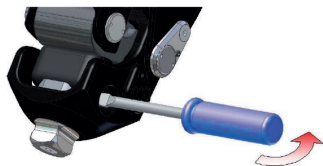
Fig. 20 Rimozione della gomma di appoggio-flessione
