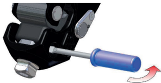
Fig. 20: Entfernen des Stand-Beuge-Gummis
