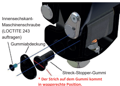
Fig. 19: Ersetzen des Streck-Stopper-Gummis
