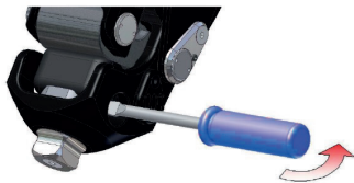
Fig. 20 Retrait du caoutchouc de flexion en phase d'appui
