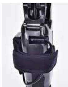
Collegare con attenzione il pacco batterie di riserva e il cavo in modo da non farlo impigliare quando il dispositivo ALLUX™ viene flesso.
