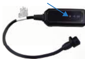
Lámpara LED en el cargador de baterías
