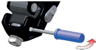
Fig. 20: Entfernen des Stand-Beuge-Gummis
