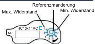
Fig. 14: Skala des Ventils zum Einstellen der Streckung
