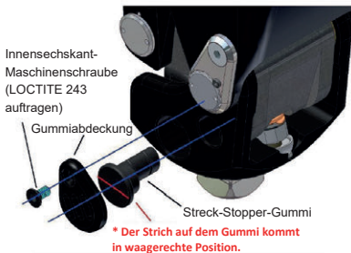
Fig. 19: Ersetzen des Streck-Stopper-Gummis
