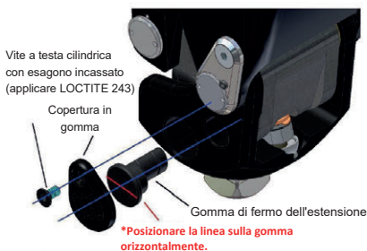
Fig. 19 Sostituzione della gomma di fermo dell'estensione
