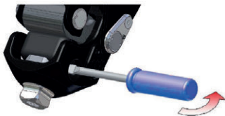
Afb. 20 Het standflexierubber verwijderen
