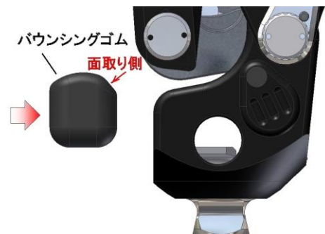
図21 バウンシングゴムの挿入
