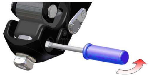
図20 バウンシングゴムの取り外し
