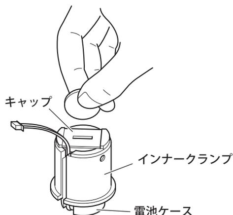
図 23 電池キャップ取外し
