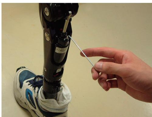
図 16 クッションバルブの締付方法
