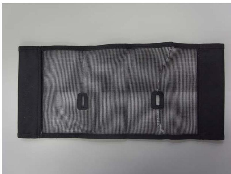
図5 座シートの破れ不具合
