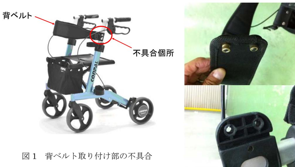
図1 背ベルト取り付け部の不具合
