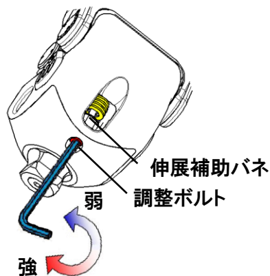
図 10 伸展補助バネの調整方法
