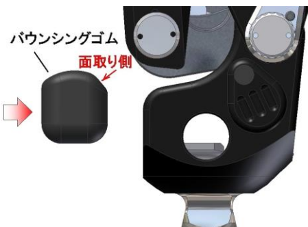
図21 バウシングゴムの挿入
