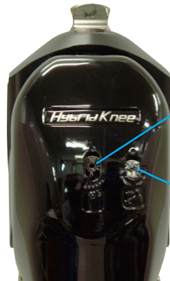
Abb. 10: Position der Stellschrauben
