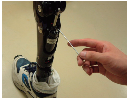
Abb. 16: Verfahren zum Anziehen des Dämpfungsventils
