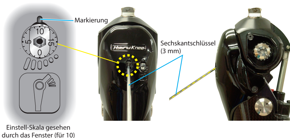
Abb. 11: Einstellen des hydraulischen Widerstands
