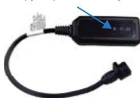
Ledlampje op de batterijlader
